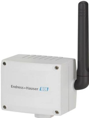
Адаптер WirelessHART Adapter SWA70 – интерфейсный модуль для беспроводной передачи сигналов 4 ... 20 мА/HART от подключенных полевых устройств в шлюз WirelessHART Fieldgate. Электропитание полевых приборов обеспечивается либо посредством батареи адаптера, либо электропитанием по месту. Адаптер WirelessHART может использоваться как во взрывоопасных, так и в безопасных зонах.
