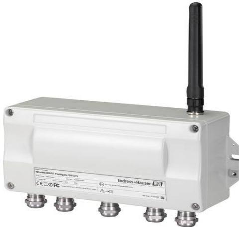
Шлюз SWG70 производства Endress+Hauser предназначен для использования в качестве интерфейса между системой, в которой используется физический уровень Ethernet или RS-485, и сетью WirelessHART. Шлюз разработан для установки во взрывоопасных зонах (Зона 2). Возможна установка встроенной или вынесенной антенны в соответствии с потребностями применения.
