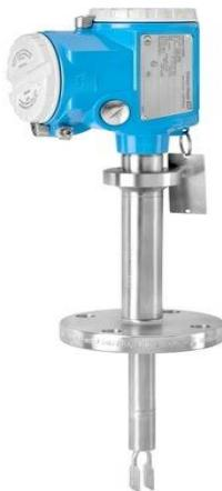
Liquiphant FailSafe FTL81 – это датчик предельного уровня для использования во взрывоопасных зонах, имеющий все международные сертификаты. Отказоустойчивая защита от перелива в областях применения с уровнем функциональной безопасности до SIL3 с использованием одного прибора. Надежные и достоверные измерения, на которые не влияют меняющиеся свойства среды, скорость потока, турбулентность, наличие пузырьков газа, пена, вибрации или налипания.
