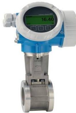
Датчик Prowirl D можно устанавливать непосредственно между фланцами, что делает его функциональным прибором во вспомогательных процессах при небольшой стоимости установки. Благодаря уникальной 2-проводной технологии датчик Prowirl D 200 обеспечивает экономичную и простую интеграцию в существующие инфраструктуры. Прибор также гарантирует высокую безопасность работы во взрывоопасных зонах. Технология Heartbeat Technology обеспечивает постоянную безопасность процесса.
