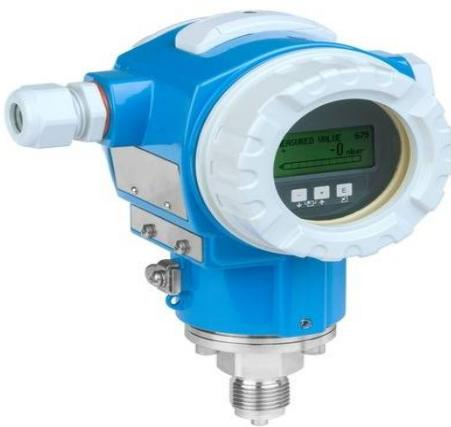
Цифровой преобразователь давления Cerabar S PMC71 с керамической мембраной используется во всех отраслях промышленности для измерения давления, уровня, объема и массы в жидкостях. Датчик обеспечивает высокую степень безопасности благодаря мемbrane из сверхчистой керамики со встроенным обнаружением повреждений. Меню быстрой настройки с регулируемым диапазоном измерения обеспечивает простую пусконаладку, сокращает затраты и экономит время. SIL2/3 в соответствии с ГОСТ Р МЭК 61508 (IEC 61508).
