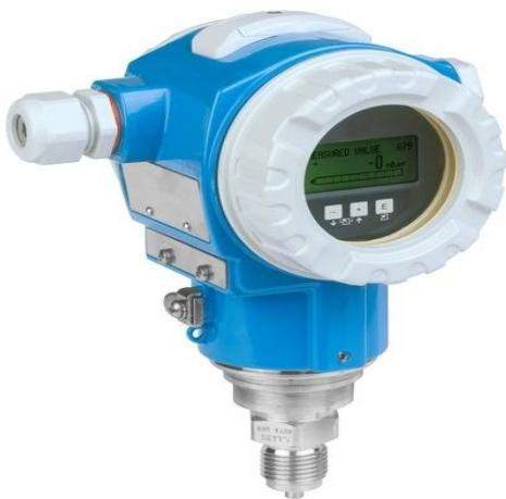
Цифровой преобразователь давления Cerabar S PMP71 с тензорезистивным принципом и металлической мембраной используется в любой отрасли для измерения давления, уровня, объема и массы в жидкостях. PMP71 разработан для решения задач с высоким давлением до 700 бар. Быстрая настройка с регулируемым диапазоном измерения. Датчик разработан в соответствии с ГОСТ Р МЭК 61508, регламентирующим функциональную безопасность систем автоматизации (SIL2).
