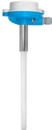
Платинородиевые термопары с керамическими термогильзами применяются для высокотемпературных точек измерения. Термогильзы, изготовленные из жаростойких материалов, служат для защиты чувствительного элемента термопары от механических и коррозионных воздействий рабочей среды в процессе эксплуатации и существенно продлевают срок службы используемых датчиков.
