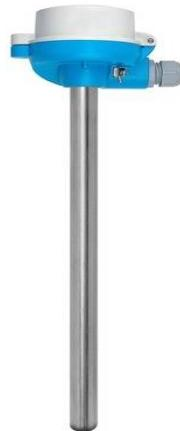
Платинородиевые термопары с керамическими или металлическими термогильзами применяются для высокотемпературных точек измерения. Термогильзы, изготовленные из жаростойких материалов, служат для защиты чувствительного элемента термопары от механических и коррозионных воздействий рабочей среды в процессе эксплуатации и существенно продлевают срок службы используемых датчиков.
