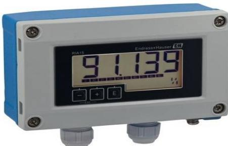
Индикатор процесса доступен в вариантах для 4...20 мА или для протокола HART®. В исполнении HART® попеременно отображается до 4 значений изм. величины от одного датчика. Для этого индикатор настраивается как Primary или Secondary Master HART® и активно опрашивает датчик для получения значений. Благодаря компактности полевого и панельного исполнений прибор легко установить в любой области применения. Небольшое падение напряжения
