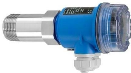
Индикатор потока для сыпучих продуктов FTR20 – это бесконтактный прибор, действие которого основано на использовании микроволн. Он идеально подходит для экономичного мониторинга массового потока (или отсутствия такового). Компактный прибор может быть использован там, где требуется экономичный мониторинг движения сыпучих продуктов. Настройка для конкретного применения может быть выполнена с помощью настраиваемых функций (включая автоматическую калибровку).
