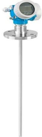
Levelflex FMP52 предназначен для измерения уровня агрессивных жидкостей с беззазорным PFA покрытием. Смачиваемые части – материалы из списка FDA. Микроимпульсный уровнемер FMP52 обеспечивает максимальную надежность даже при смешении поверхности. Levelflex FMP52 используется для непрерывного измерения уровня жидкостей, паст и пульп, а также в качестве прибора определения раздела фаз. На процесс измерения не влияет изменения среды, температуры, наличия прослоек газа или пара.
