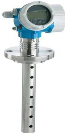
Leveflex FMP55 с технологией SensorFusion представляет собой первое в мире устройство, объединяющее преимущества емкостного и микроимпульсного радарного уровнемеров. Leveflex FMP55 SensorFusion обеспечивает одновременное измерение общего уровня взлива и межфазного уровня при любой толщине и типе эмульсионного слоя. Это позволило многопараметрическому уровнемеру FMP55 поднять стандарты в измерении границы раздела фаз, особенно в нефтегазовой, химической и нефтехимической отраслях.
