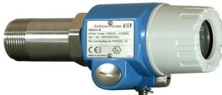
Микроволновый барьер FDR50 использует принцип бесконтактного измерения для определения предельного уровня. Его можно устанавливать в контейнерах, трубопроводах, обычных скважинах или скважинах со свободным падением жидкости. Измерение может осуществляться снаружи через корпус контейнера, изготовленного из неметаллических материалов. Подходит в качестве переключателя уровня для контроля и учета всех типов сыпучих продуктов. Используется с излучателем FQR50.
