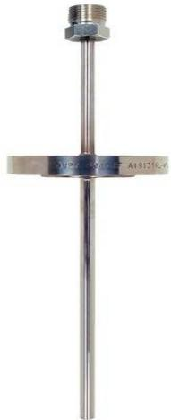
Термогильза представляет собой металлическую трубку с фланцевым присоединением к процессу и резьбовым присоединением к термометру, имеет удлинительную шейку. Доступен широкий выбор фланцевых присоединений к процессу и материалов погружной части. Внутренний диаметр гильзы подходит для монтажа термометров сопротивления или термопар с диаметром зонда 3 или 6мм.
