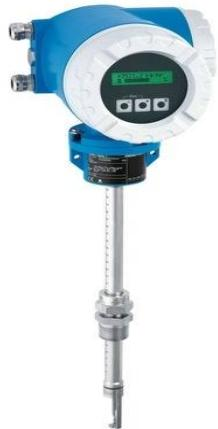
t-mass 65I имеет врезное исполнение и разработан для прямого измерения массового расхода промышленных газов и сжатого воздуха. Расходомер имеет динамический диапазон 100:1 и позволяет точно измерять рабочий расход и утечки. В прибор встроена возможность моделирования многокомпонентного (до 8 компонент) состава газа из 20 типовых газов. Данное исполнение t-mass 65I подходит для трубопроводов круглого и прямоугольного сечения.
