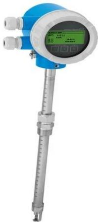
Врезное исполнение t-mass B 150 подходит для крупных труб или вентиляционных коробов прямоугольного сечения. Прибор разработан для экономичного измерения бытовых газов, в частности сжатого воздуха. Он предназначен для мониторинга потока на низших уровнях распределения. Прибор имеет прочный компактный алюминиевый корпус и выполнен по 4-проводной схеме. Настройки пользователя сохраняются в дисплейном модуле и могут быть перенесены с одного устройства на другое посредством этого модуля.
