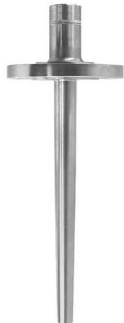
Для применения термометра в тяжелых промышленных условиях рекомендуется осуществлять расчет прочностных характеристик термогильзы по стандартам DIN 43772 и ASME PTC 19.3. Проверка качества готового изделия осуществляется при испытаний проникающим красителем, ультразвуковой дефектоскопией, статическим давлением и прочими методами неразрушающего контроля.
