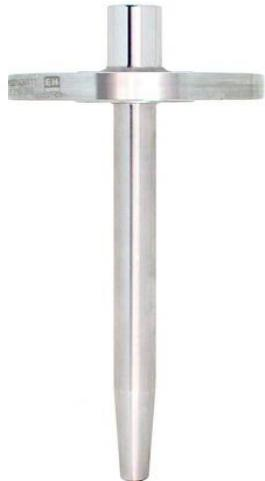
Для применения в тяжелых промышленных условиях необходим расчет прочностных характеристик термогильзы. Проверка качества готового изделия осуществляется неразрушающими испытаниями выходного контроля: проникающим красителем (качество сварных швов), ультразвуковой дефектоскопией (наличие микротрещин), испытаниями на утечку гелия и статическим давлением (целостность и герметичность конструкции).
