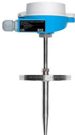
Универсальная термопара ТС15 предназначена для применений в любых отраслях промышленности. Для повышения надежности измерения температуры, термопара опционально комплектуется нормирующим преобразователем с различными типами прокола передачи данных (4/20mA, HART, Profibus PA, FOUNDATION Fieldbus). Различные присоединения к процессу и материалы смачиваемых частей обеспечивают универсальность применения.
