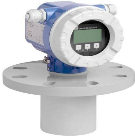
Prosonic FMU44 подходит для бесконтактного измерения уровня в жидкостях, пастах, сыпучих материалах или измерения расхода в открытых каналах или измерительных водосливах. Двухпроводный или четырехпроводный компактный прибор может использоваться в складских резервуарах, резервуарах с мешалками и на конвейерах. Огибающая кривая может отображаться на дисплее, упрощая диагностику. Функция линеаризации (до 32 точек) для конвертирования измеренного значения в любую единицу длины, объема или расхода
