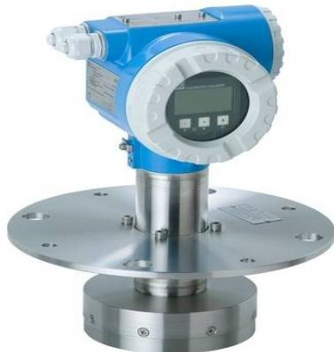
Micropilot FMR532 используется для коммерческого учета и управления запасами, сертификаты NMi и PTB Он соответствует применимым требованиям по OIML R85 и API 3.1B. Радарный уровнемер FMR532 с планарной антенной предназначен специально для применения в байпасах и измерительных трубах. Установка FMR532 экономична и проста, производится с помощью 4-жильного кабеля с HART и искробезопасным источником питания на 24В постоянного тока.
