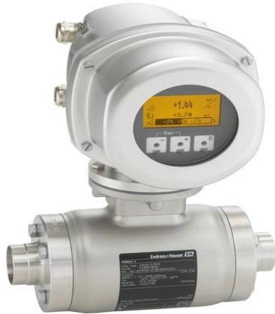
Promag H – лучший датчик для высокотребовательных применений в пищевой и фармацевтической отрасли. В сочетании с преобразователем Promag 55 с сенсорным управлением, 4x-строчным дисплеем и расширенным функционалом, включающим программное обеспечение для определения расхода твердых частиц, очистки электродов и расширенной диагностики, Promag 55H обеспечивает высочайшую точность измерения при выполнении самых сложных измерительных задач.
