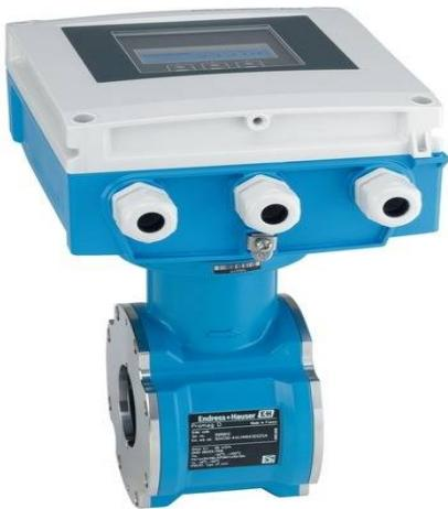
Бесфланцевый расходомер Promag D разработан для базовых применений в водоснабжении и водоотведении в ограниченном пространстве. Инновационная конструкция его корпуса обеспечивает адаптируемое и быстрое центрирование, а также снижение затрат на монтаж. Promag D 400 экономит ваше время и деньги благодаря широкому функционалу преобразователя, специализированного для измерения расхода воды. Кроме того, технология Heartbeat непрерывно обеспечивает соответствие нормам и безопасность процесса.
